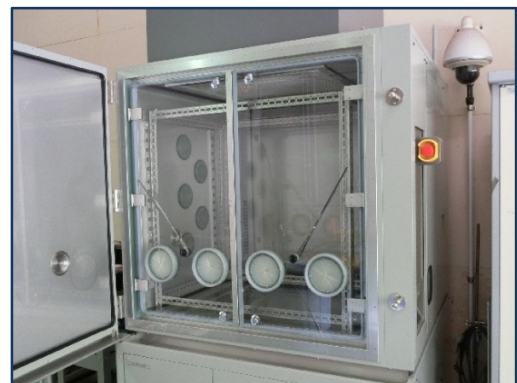
超低温恒温恒湿槽（-70～150℃）
